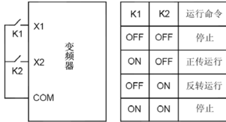
图5-2-1 两线式控制（使能与方向合一）
