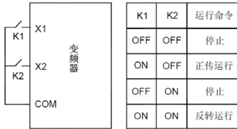
图5-2-2 两线式控制（使能与方向分离）
